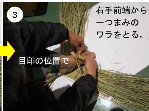
3 右手前端から一つまみのワラをとる。 目印の位置で ワラを撚って左へ。2に重ねる
