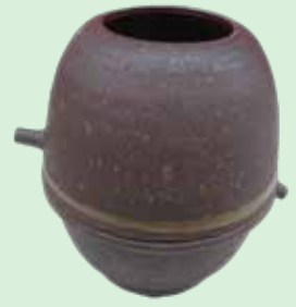
「白岩焼ランビキ」(当館蔵) もろみから焼酎を醸造する道具
